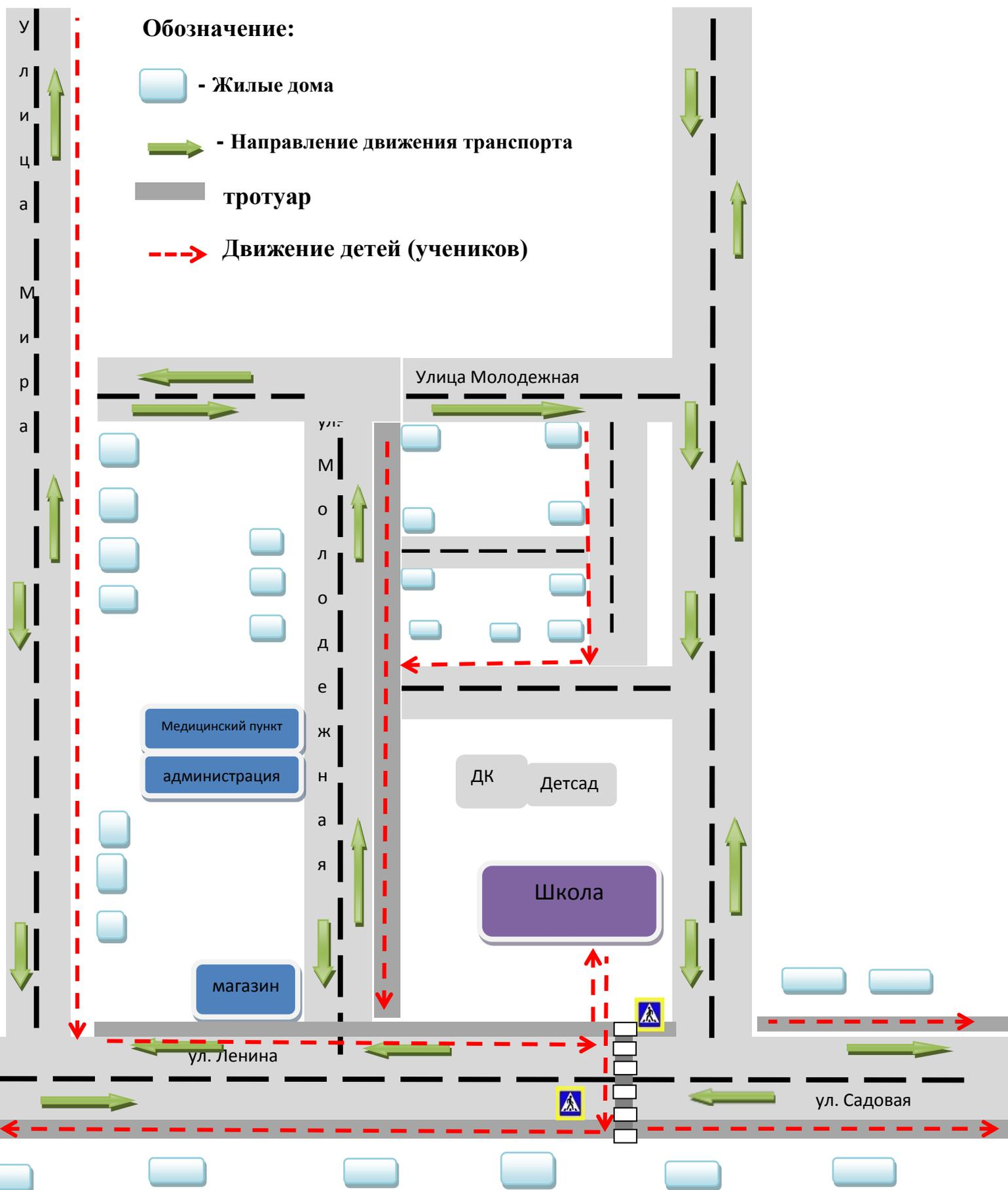
**6. План-схема пути движения транспортных средств и детей при проведении дорожных ремонтно-строительных работ вблизи МБОУ «Булановская ООШ»**
